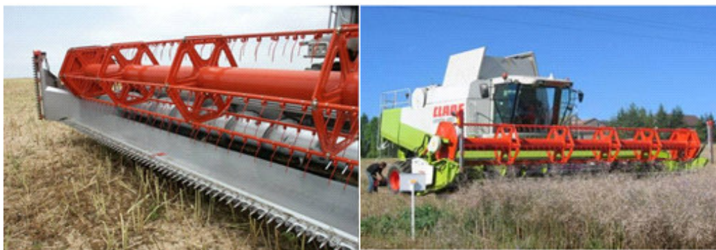
شکل ۱۳- استفاده از هد مخصوص کلزا با تیغه برش عمودی
